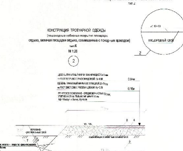
КОНСТРУКЦИЯ ЗЕМЛЯНОГО ПОЛОТНА ТРОТУАРА
